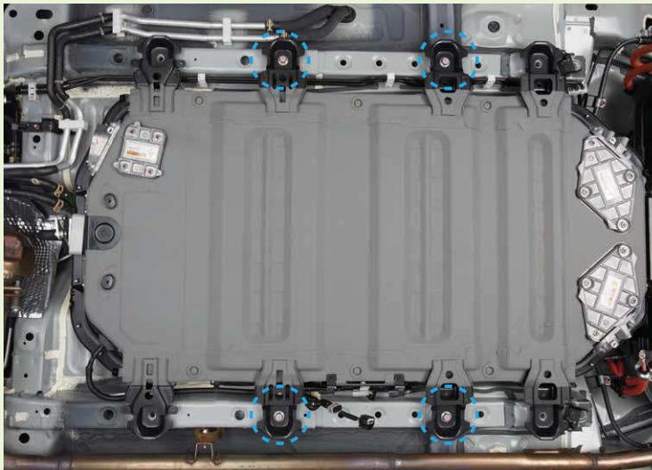
⑤ 駆動用バッテリーの下面が角材に当たる直前まで、リフトで車両を下降させる。
